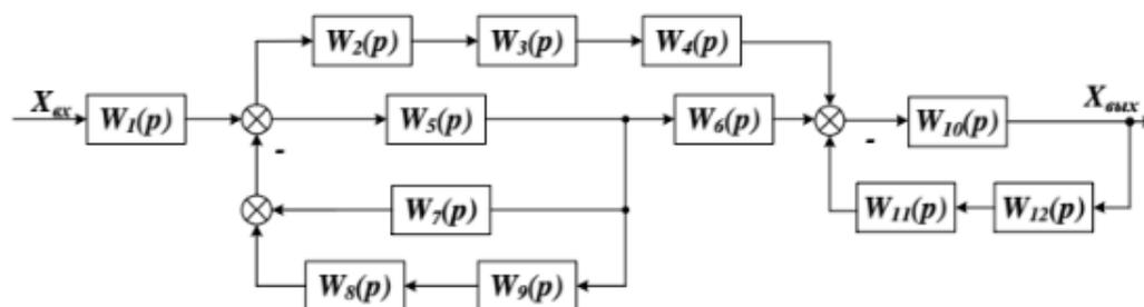
Задание №2. Построить сигнальный граф и выразить передаточную функцию системы через передаточные функции ее звеньев по структурной схеме системы управления, заданной в первом задании, по правилу Мейсона.
