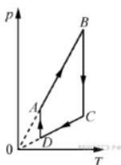
На рисунке представлен график цикла, проведённого с одноатомным идеальным газом. На каком из участков внутренняя энергия газа уменьшалась? Количество вещества газа постоянно.
