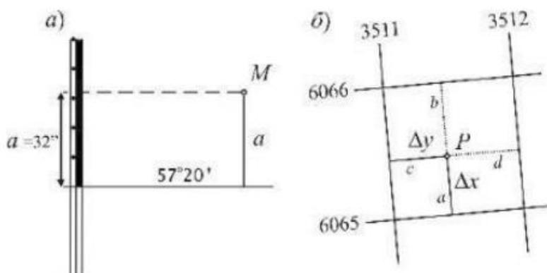
Рисунок 2 - Определение координат точек: а - географических; б - прямоугольных.
