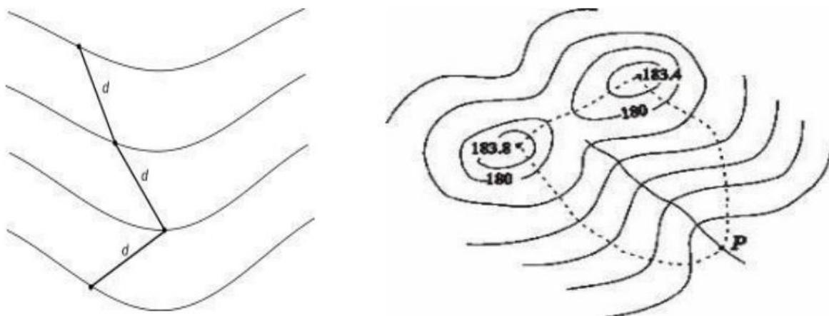
Рисунок 4 - Построение линии с заданным уклоном
