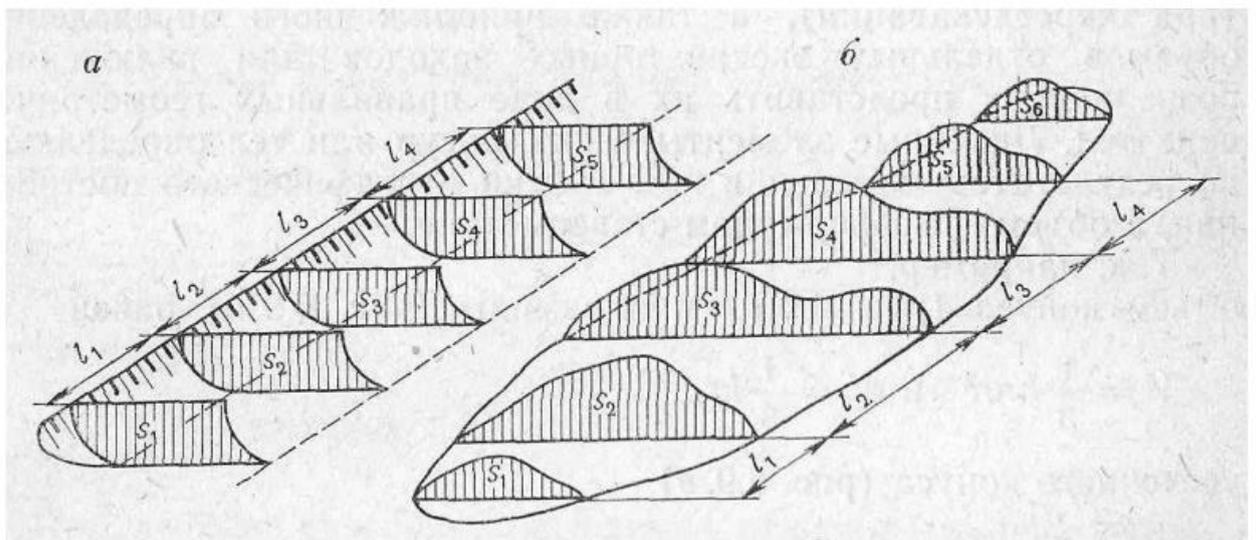
$$V = Sl_1 + l \left( \frac{S_1 + S_n}{2} + S_2 + S_3 + \dots + S_{n-1} \right) + S_n l_{n+1}, \text{ где}$$
