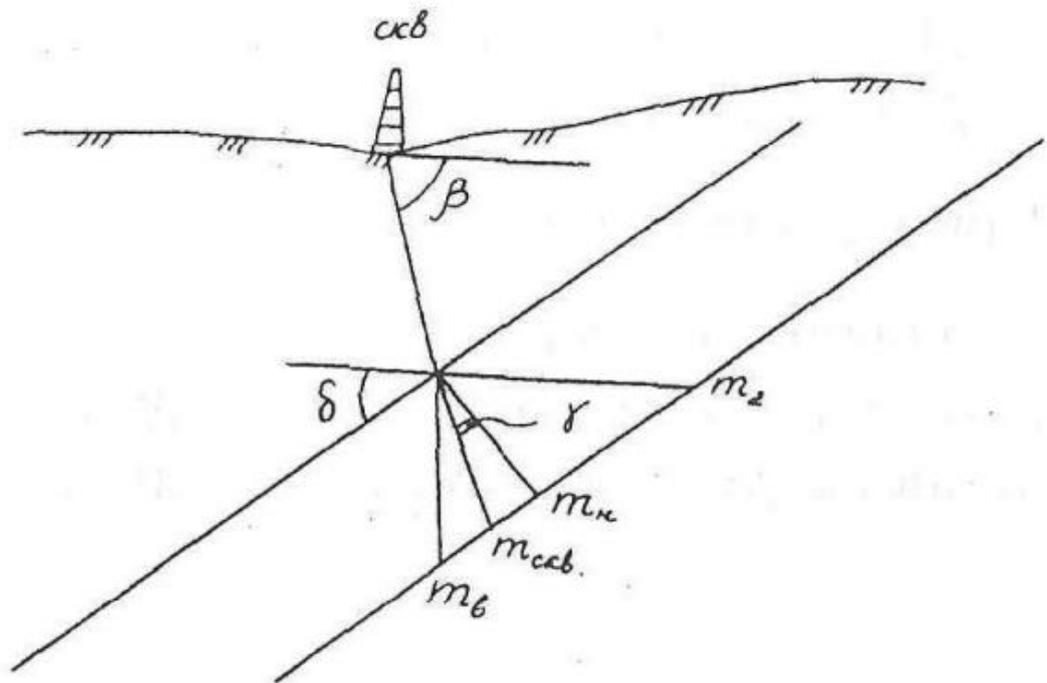
Глубина залегания  $h_3$  полезного ископаемого- расстояние по вертикали от земной поверхности до висячего бока залежи.:  $h_3 = N_u - N_{кр}$  ,где  $N_u, N_{кр}$ — абсолютные отметки соответственно устья скважины и кровли залежи. Примеры решения задач
