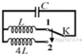
Как изменится период собственных электромагнитных колебаний в контуре (см. рисунок), если ключ  $K$  перевести из положения 1 в положение 2?
