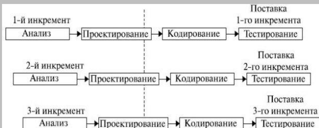
Рис. 5.9. Инкрементная модель разработки программного обеспечения
