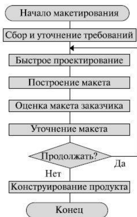
Рис. 5.8. Последовательность действий при макетировании программного обеспечения
