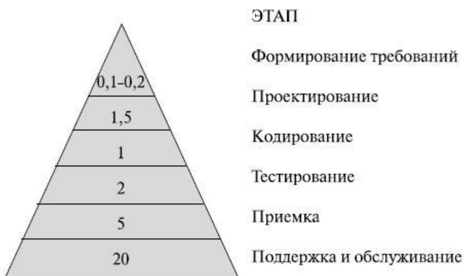
Рис. 5.6. Зависимость стоимости и устранения ошибки от стадии разработки программного обеспечения
