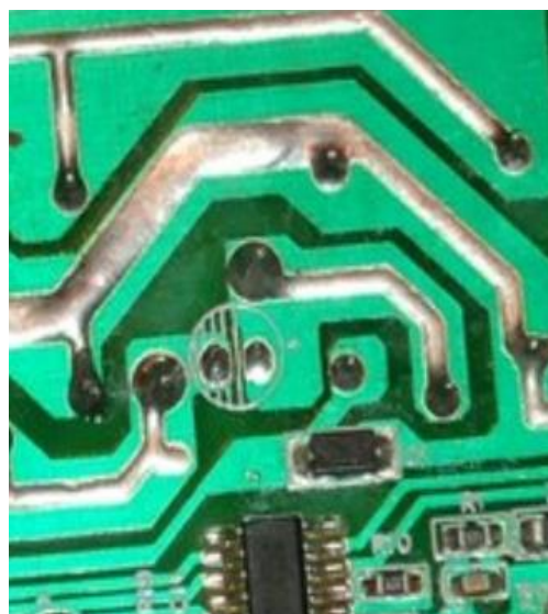
Трассировка силовых линий
