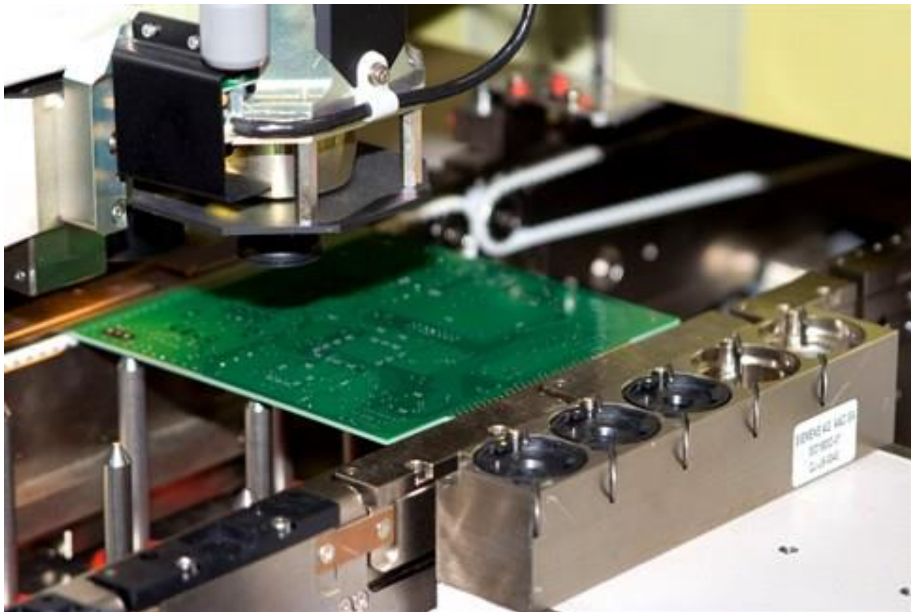
Процесс автоматизированной пайки
