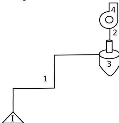
Рис. Аксонометрическая схема аспирационной системы с отсосом воздуха I
