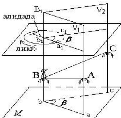
Рассмотрим двугранный угол между вертикальными плоскостями **V1** и **V2**, проходящими через стороны угла **ABC**. Угол  $\beta$  для данного двугранного угла является линейным. Следовательно, углу  $\beta$  равен всякий другой линейный угол, вершина которого находится в любой точке на отвесном ребре **BB1** двугранного угла, а стороны его лежат в плоскости, параллельной плоскости **M**. Итак, для измерения величины угла  $abc = \beta$  можно в любой точке,
