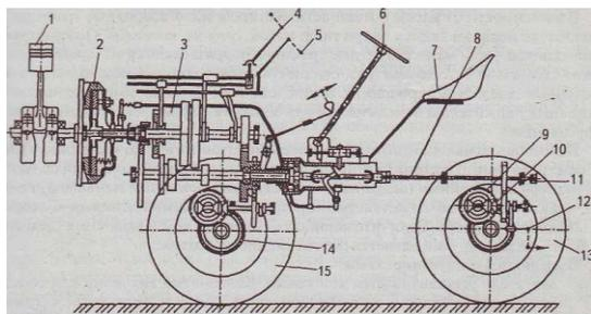
Общий вид малогабаритного трактора: 1 — двигатель; 2 — сцепление; 3 — коробка передач; 4 — рукоятка переключения передач; 5 — рычаг заднего хода; 6 — рулевое управление; 7 — сиденье; 8 — соединительный вал; 9 — главная передача Заднего моста; 10 — дифференциал; 11 — вал отбора мощности; 12 — рычаг переключения привода задних колес;
