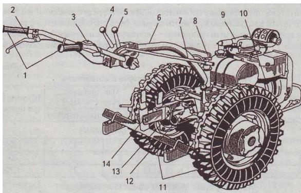
Общий вид мотоблока: 1 — рукоятка управления; 2— рычаг управления сцеплением; 3 — рычаг газа; 4 — рычаг реверса; 5 — рычаг переключения передач; 6, — рулевая штанга; 7—рычаг включения вом-а; 8 — бензобак; 9 — воздушный фильтр; 10 — двигатель; 11 — колеса; 12 — сцепка вом-а; 13 — стойка; 14—прицеп.
