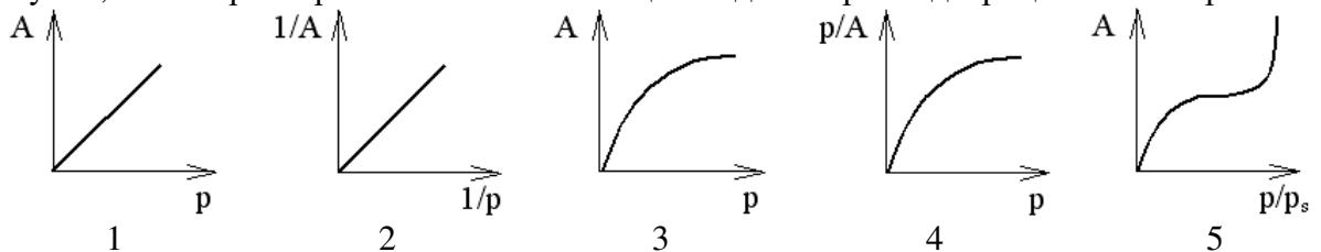
9. А – адсорбция;  $A_{\infty}$  – максимальная адсорбция;  $K$  – константа адсорбционного равновесия;  $\alpha$  – угол наклона прямой;  $c$  – равновесная концентрация адсорбата. Рисунок, на котором правильно показана изотерма адсорбции в координатах линейной формы уравнения Ленгмюра.
