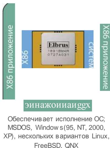
*Еще на этапе проектирования МП Эльбрус у разработчиков было понимание важности поддержки программного обеспечения, написанного для архитектуры Intelx86. Для этого была реализована система динамической (т.е. в процессе исполнения программы, или «на лету») трансляции двоичных кодов x86 в коды процессора Эльбрус. Фактически, система двоичной трансляции создает виртуальную машину, в которой исполнения программ*
