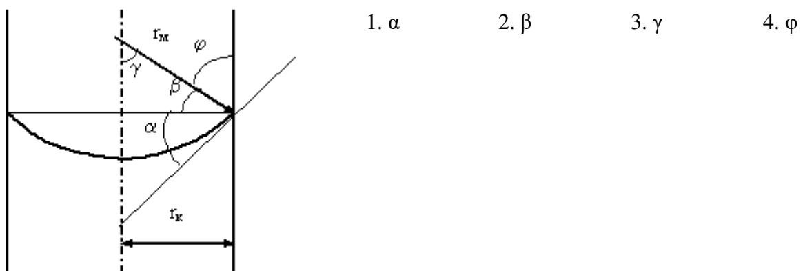
10.  $\frac{ds}{dV}$  – кривизна поверхности жидкости;  $\sigma_{t-g}$  и  $\sigma_{t-j}$  – поверхностные натяжения на границах твердого тела с газовой фазой и жидкостью, соответственно;  $\theta$  – краевой угол. Жидкость не будет самопроизвольно пропитывать пористое тело при условии
