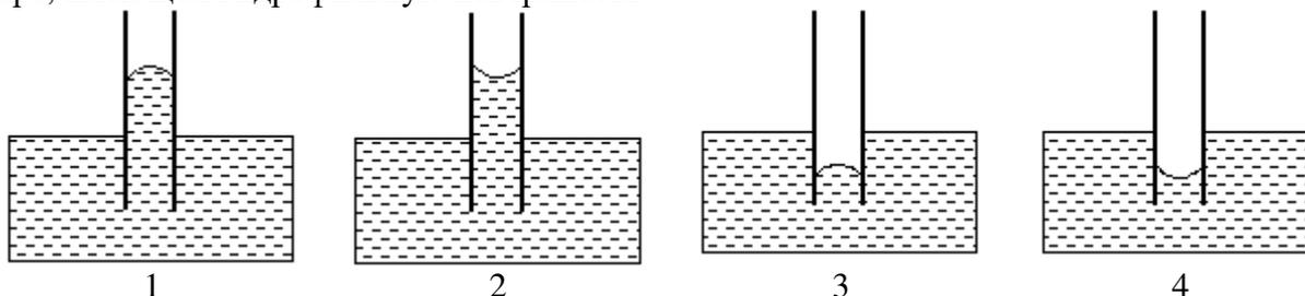
2. Рисунок, на котором правильно показано положение и форма мениска воды в капилляре, имеющем гидрофобную поверхность.
