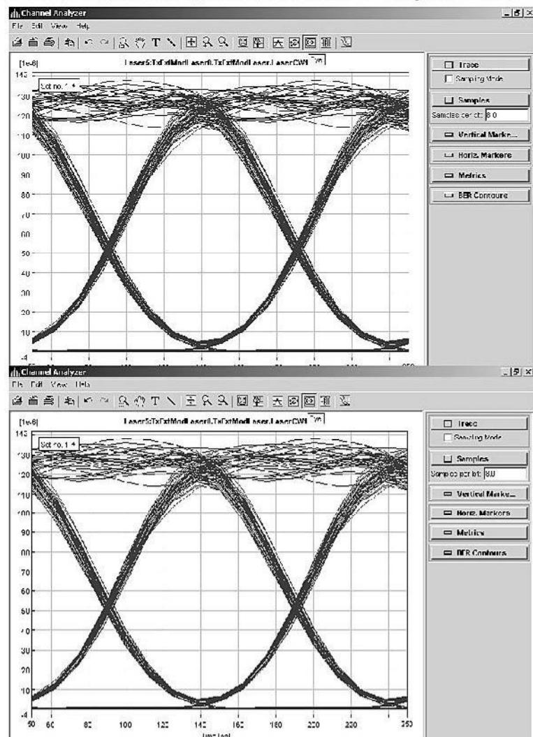
линейного тракта волоконно-оптической линии, полученный с помощью анализатора канала представлен на рисунке. Определите скорость передачи сигнала в линии и время нарастания фронта импульса
