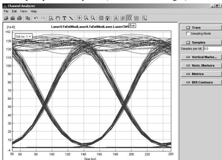
**Задача №8.** Результат измерений многократного наложения битовых последовательностей (глаз-диаграмма) на выходе линейного тракта волоконно-оптической линии, полученный с помощью анализатора канала представлен на рисунке. Определите скорость передачи сигнала в линии и время нарастания фронта импульса
