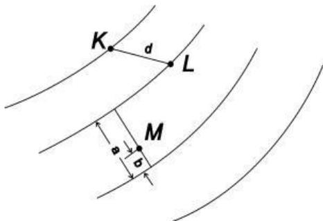
Рис. 3. Определение высоты точки  $M$  и уклона на отрезке  $KL$
