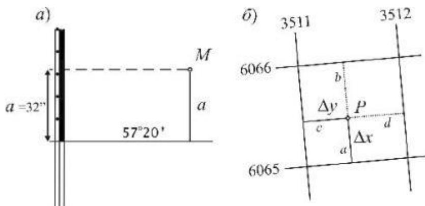
Рис. 2. Определение координат точек: а - географических; б - прямоугольных.
