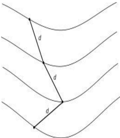
Рис. 5. Построение линии с заданным уклоном
