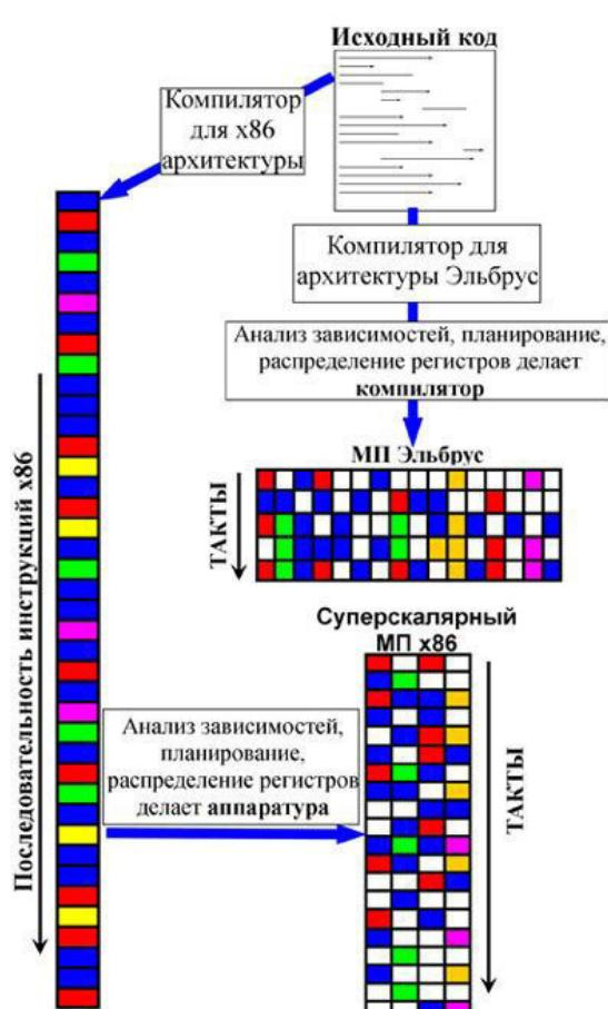
В традиционных архитектурах типа RISC или CISC (x86, PowerPC, SPARC, MIPS, ARM), на вход процессора поступает поток инструкций, которые рассчитаны на последовательное выполнение. Процессор
