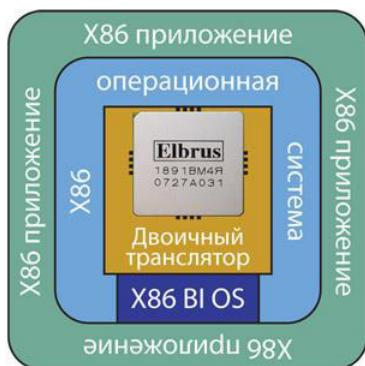
*Еще на этапе проектирования МП Эльбрус у разработчиков было понимание важности поддержки программного обеспечения, написанного для архитектуры Intel x86. Для этого была реализована система динамической (т.е. в процессе исполнения программы, или «на лету») трансляции двоичных кодов x86 в коды процессора Эльбрус. Фактически, система двоичной трансляции создает виртуальную машину, в которой*
