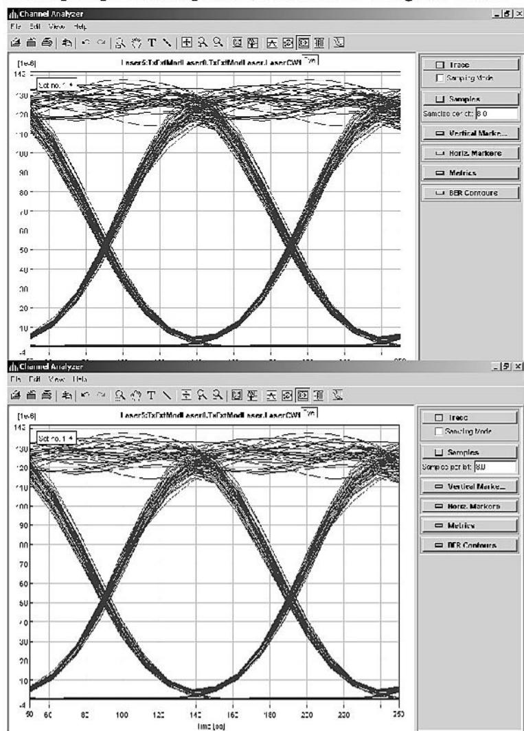
линейного тракта волоконно-оптической линии, полученный с помощью анализатора канала представлен на рисунке. Определите скорость передачи сигнала в линии и время нарастания фронта импульса
